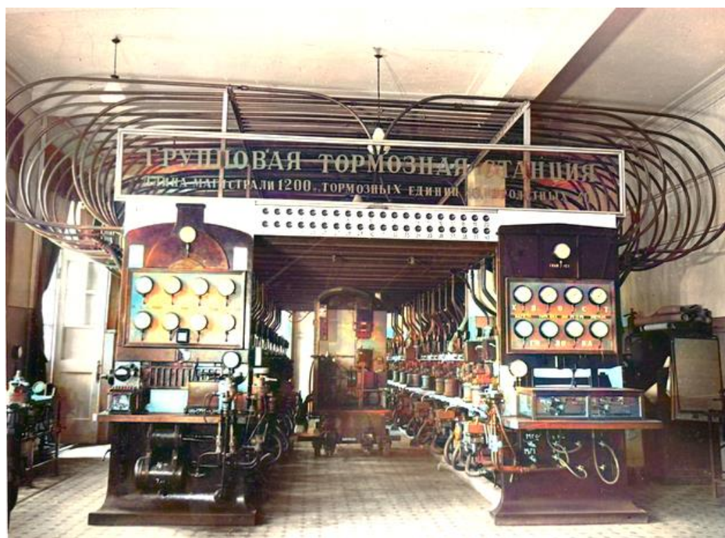
Рисунок 4.3 – Фотоснимок групповой тормозной станции кафедры «Вагоны и вагонное хозяйство» РУТ(МИИТ)
